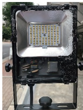
NLFL投光燈 燈具玻璃破碎情況
